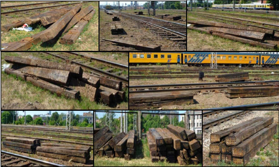
4. att. Nolietoto koka gulšņu veidošanās procesi Rīgas centrālās stacijas dzelzceļu tīklā (Autora foto 07.06.2008)
