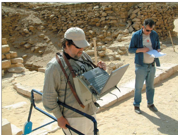
Pazemes galeriju izpēte ar georadaru. Ar aparatūru inž. Georgijs Šicovs, blakus LU prof. Valdis Segliņš.
