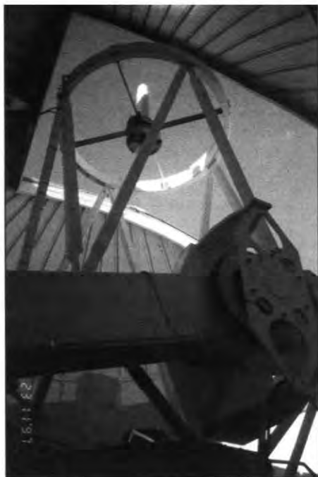
10. att. 1,55 m infrasarkanais Karlosa Sančesa teleskops.
