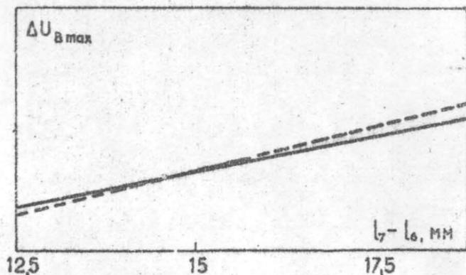
Рис. 12. Зависимость  $\Delta U_{вmax}$  от расстояния между ячейками.  $l_1=30$  мм;  $l_2-l_1=0$ ;  $l_7-l_6+l_3-l_2=67$ .
