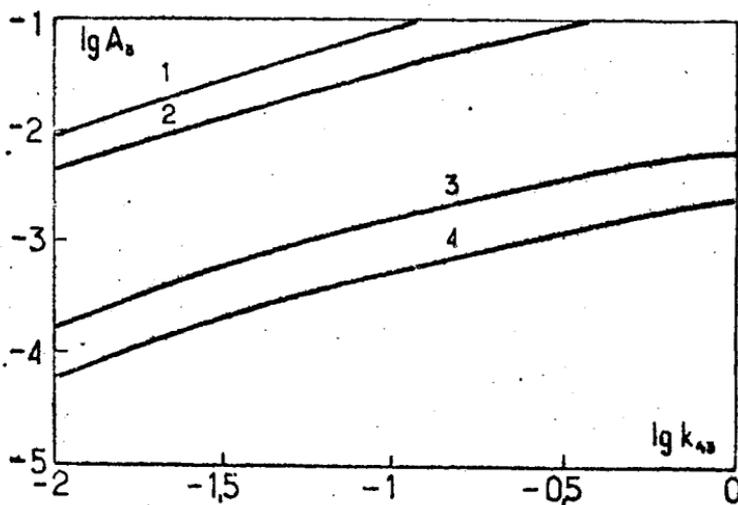
Рис.5. Зависимость взаимного влияния ячеек теплофизических свойств материалов термоэлементов и детектора  $h_5=0, q_{*}=0,1$ ; 1)  $h_4=1$ ; 2)  $h_4=10$ ;  $q_{*}=1$ ; 3)  $h_4=1$ ; 4)  $h_4=10$ .
