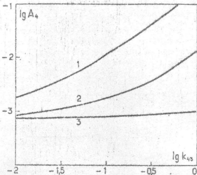
Рис. 8. Зависимость повторяемости от теплофизических свойств материалов термоэлементов и детектора  $K=0,01$ ,  $q_{\neq} 0,1$ ; 1)  $h_4=1$ ; 2)  $h_4=10$ ; 3)  $h_4=100$ .
