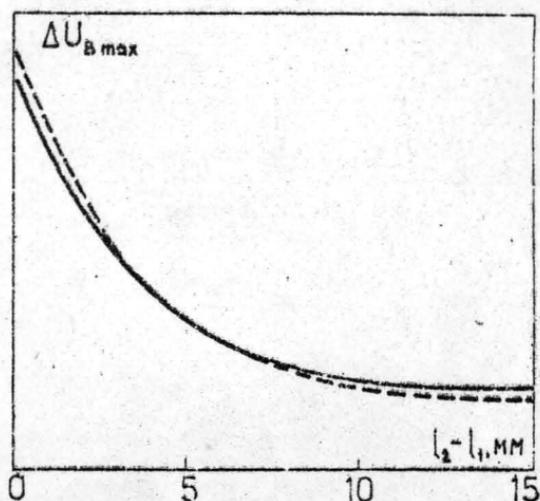
Рис. II. Зависимость  $\Delta U_{B \max}$  от толщины слоя изоляции  $l_2 = 30 \text{ мм}$ ,  $l_7 - l_6 + l_3 - l_2 = 67 \text{ мм}$
