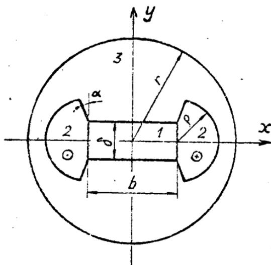
Рис.1. Двумерная модель магнитной системы кондукционного насоса 1- рабочая зона (канал насоса), 2- токопроводящие шины, 3- стальной магнитопровод.
