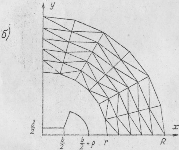
Рис.3. Деление области расчета на конечные элементы :
