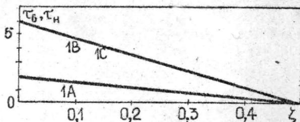
Рис.3. Касательные напряжения в склейке при  $=0,5 \text{ атм.}$
