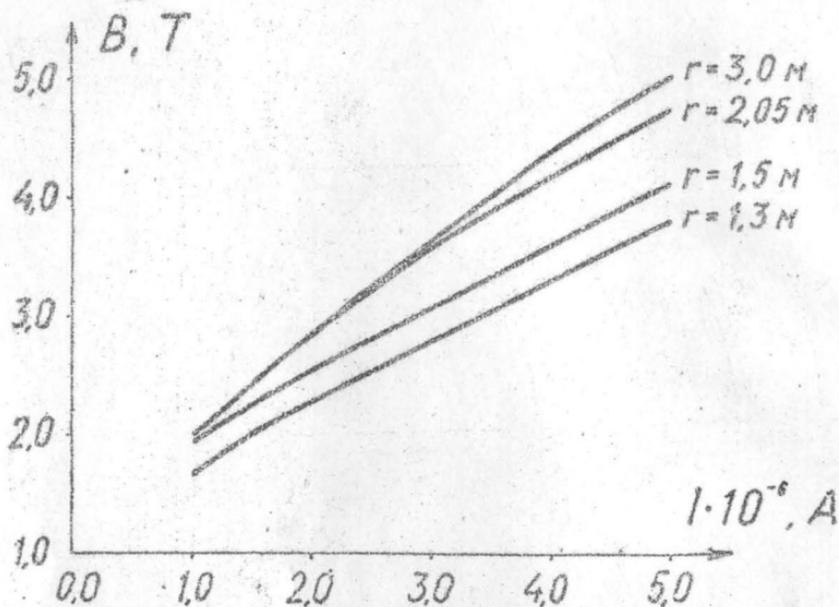
Рис.5. Зависимость индукции поля в центре канала от тока при фиксированном радиусе магнитопровода.
