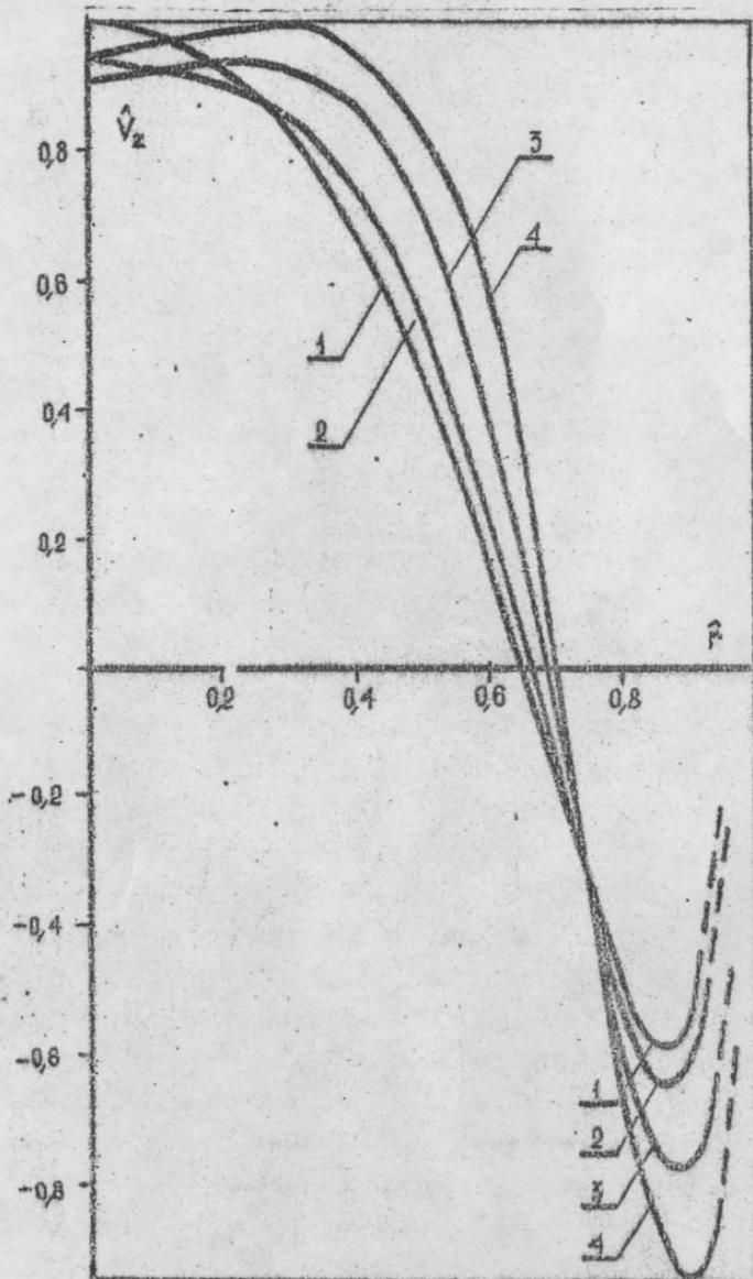
Рис. 2. Распределение аксиальной составляющей скорости по радиусу для различных значений эффективного числа Рейнольдса:
