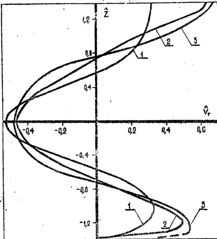
Рис. 4. Распределение радиальной составляющей скорости по высоте расплава при  $\hat{r}=0,6$  :
