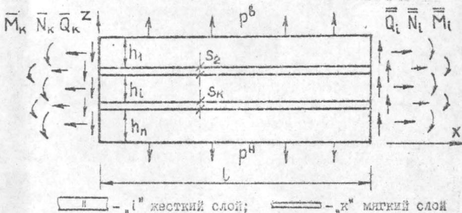
Рис. 1. Поперечное сечение многослойной прямоугольной пластины.
