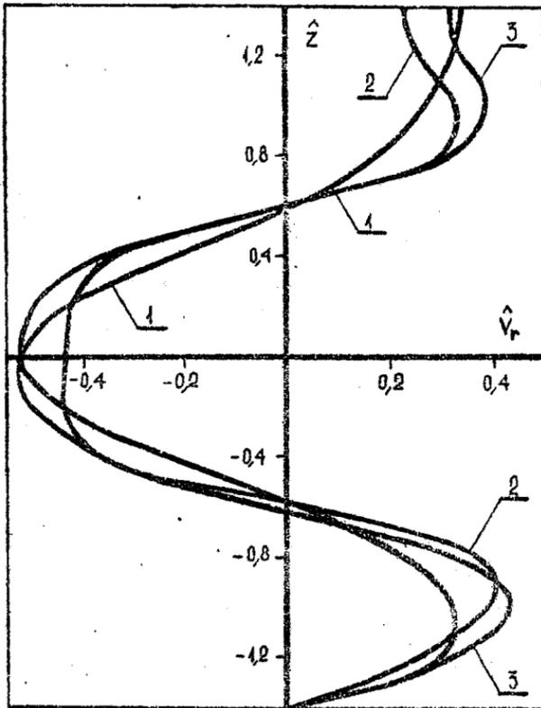
Рис.6. Распределение радиальной составляющей скорости по высоте расплава при  $\hat{\beta} = 0,5$  (нумерация кривых как на рис.5).
