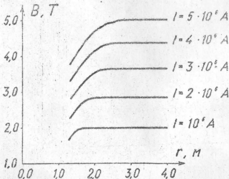
Рис.6. Зависимость индукции поля в центре канала от радиуса магнитопровода при фиксированном токе..
