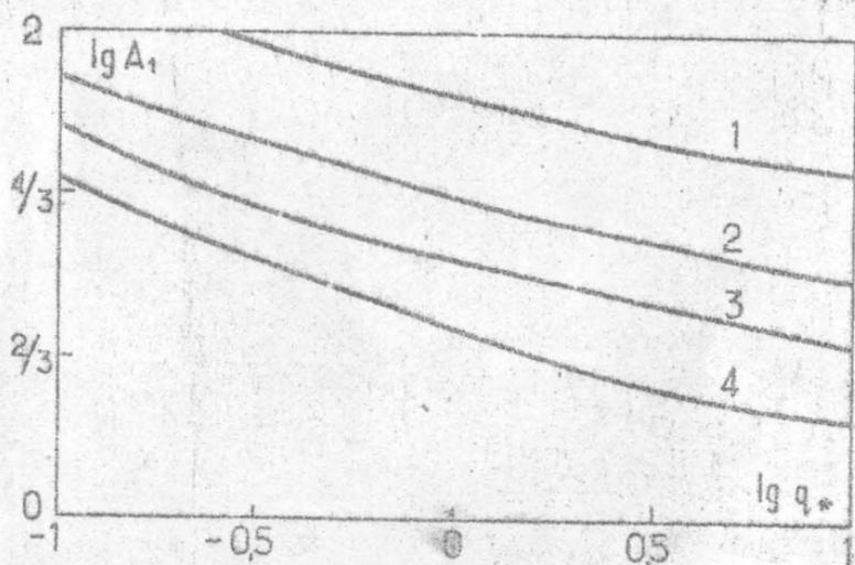
Рис. 3. Зависимость защищенности от скорости химической реакции  $h_1=2, h_3=6, h_5=4$ ;
