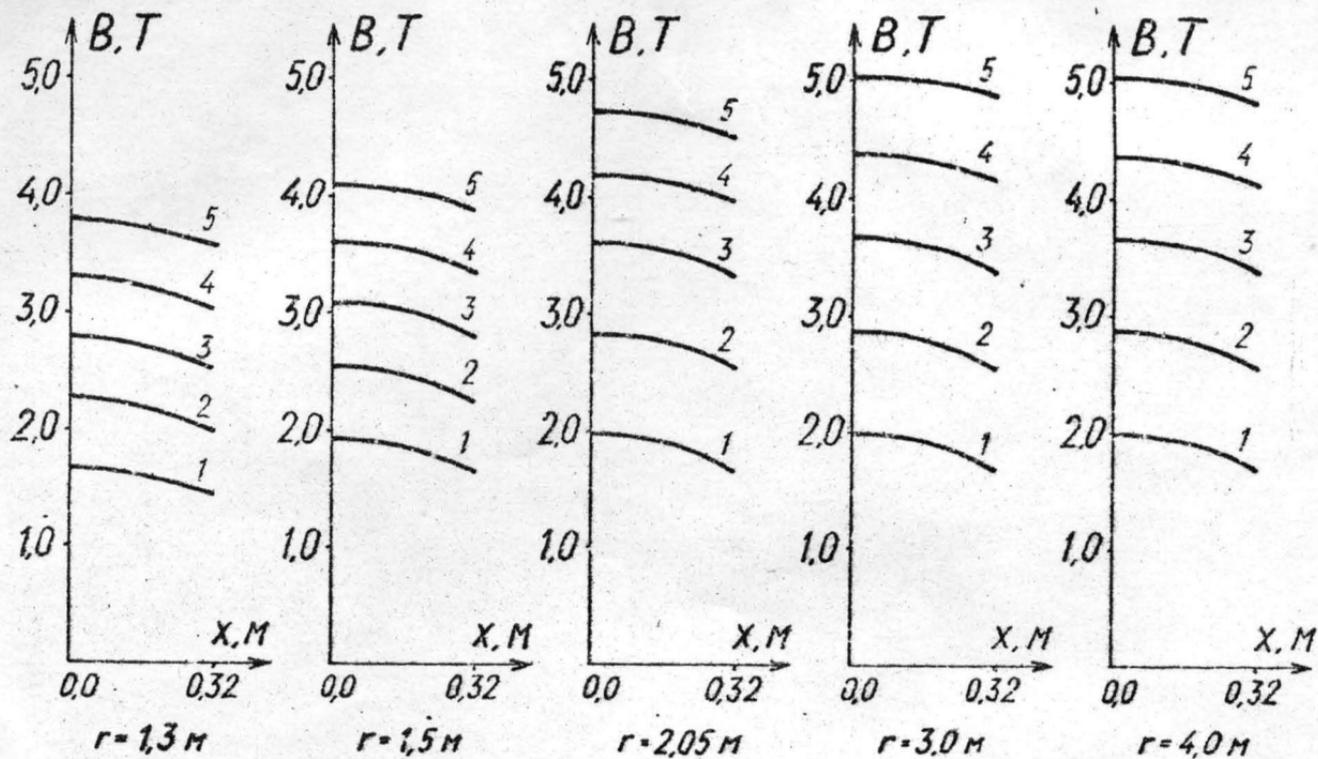
Рис. 4. Распределения поля вдоль оси  $x$  в пределах половины канала при различных значениях тока  $I$  и радиуса магнитопровода  $r$ . Числа на графиках соответствуют значениям тока в мегаамперах.
