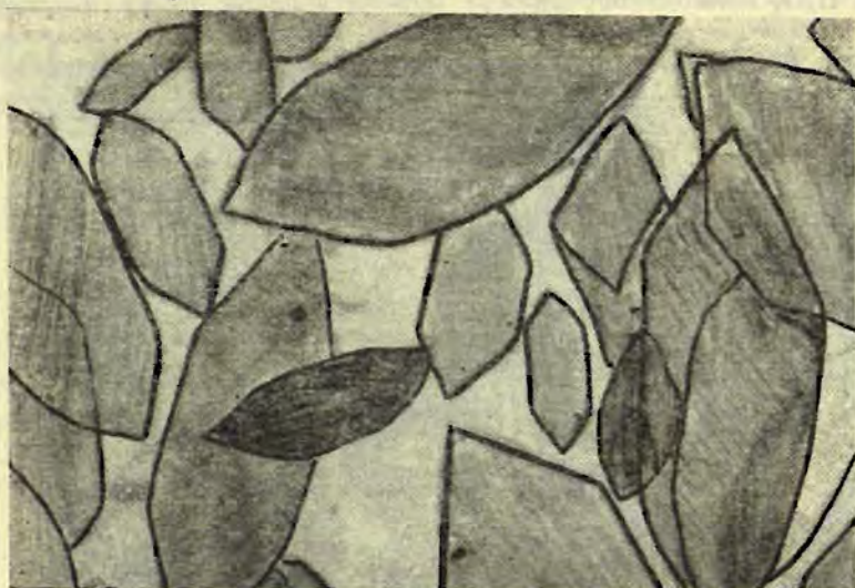
Рис. 2. Кристаллы \text{CaO} \cdot \text{B}_2\text{O}_3 \cdot 6\text{H}_2\text{O} , полученные при 30^\circ\text{C} . Увеличение \times 54 .
