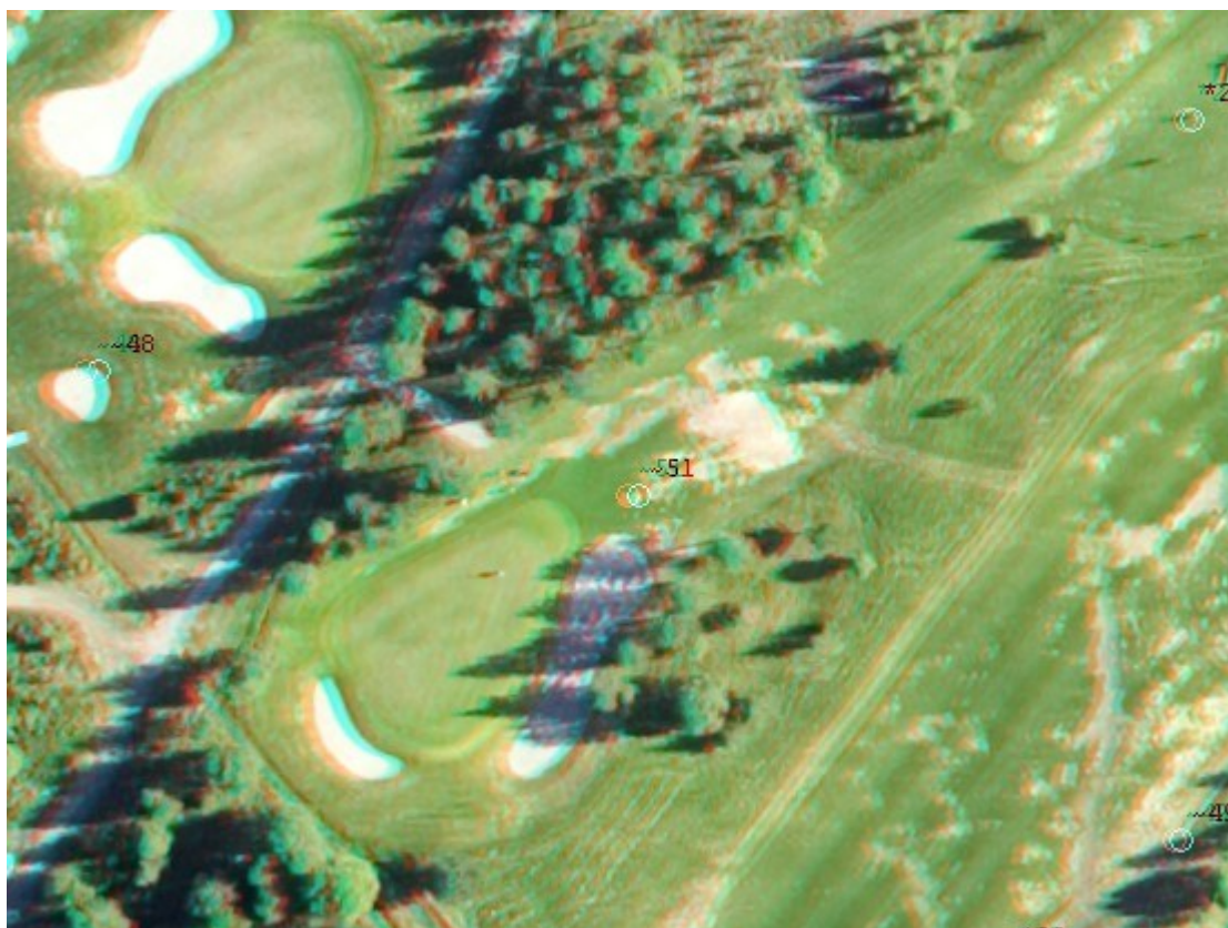
Att. KomSR2. Anaglifu stereoattēls, kas uz aerofoto pamata radīts pie golfa laukuma projektēšanas. Par anaglifu tehniku skatīt lekciju Pielikumā 1, vai, piemēram, http://en.wikipedia.org/wiki/Anaglyph_3D .
