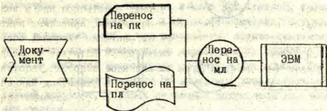
Рис. I. Подготовка данных с использованием перфоносителей
