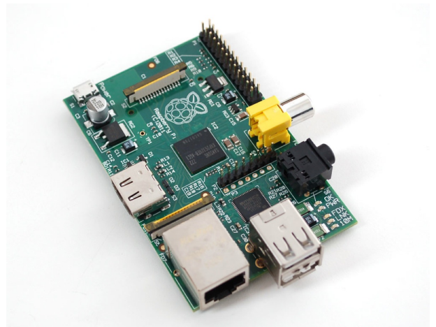
Att. 2.7.: Raspberry Pi Model B iekārta
