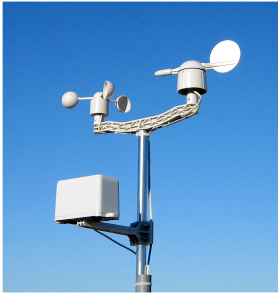
Att. 5.7.: Vēja virziena, vēja stipruma un nokrišņu daudzuma sensori
