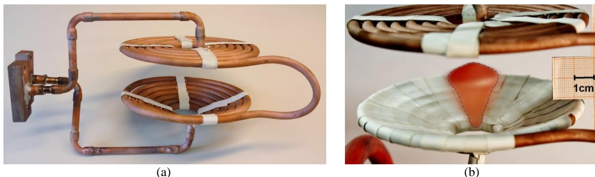
Attēls 5. Induktors klasiskā levitācijas eksperimenta atkārtošanai [6] (a) un laikā vidējotā levitējošā izkausētā alumīnija ( m = 18.6 g) brīvās virsmas forma (b)
