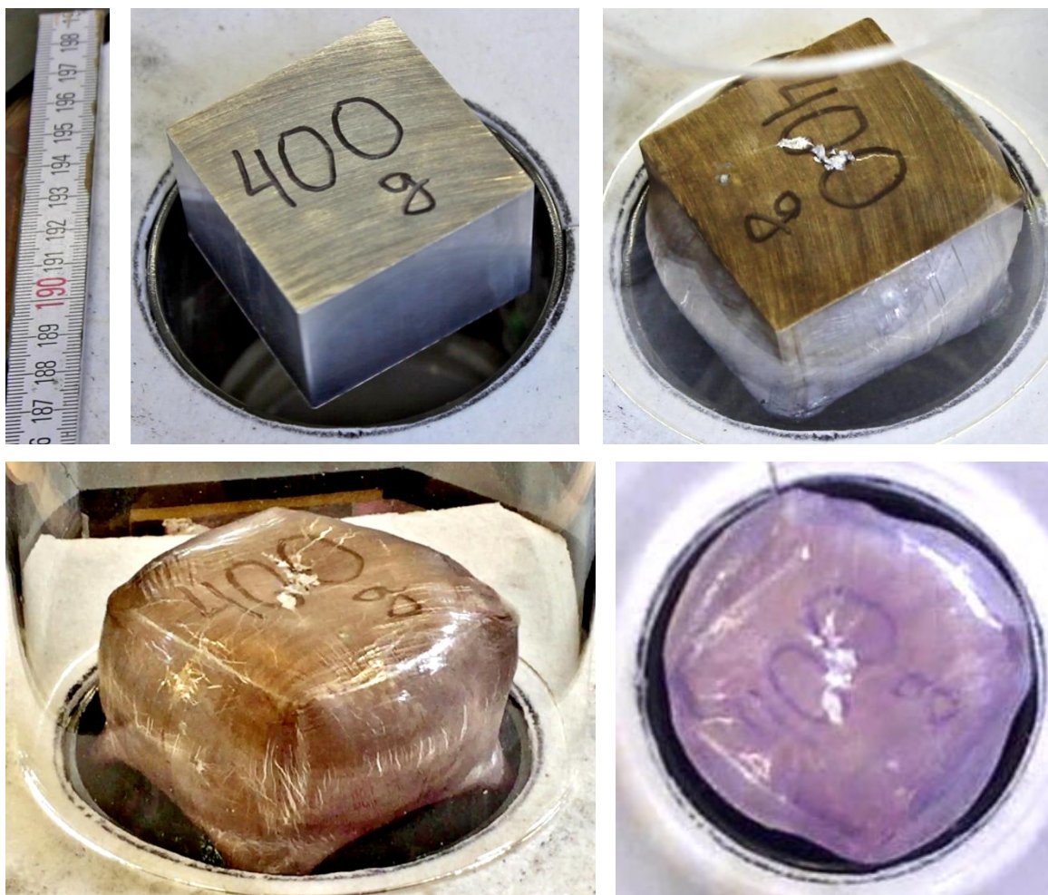
Attēls 25. Alumīnija parauga (400 g) bezkontakta levitācijas kausēšana pie I_{ef} = 780 A
