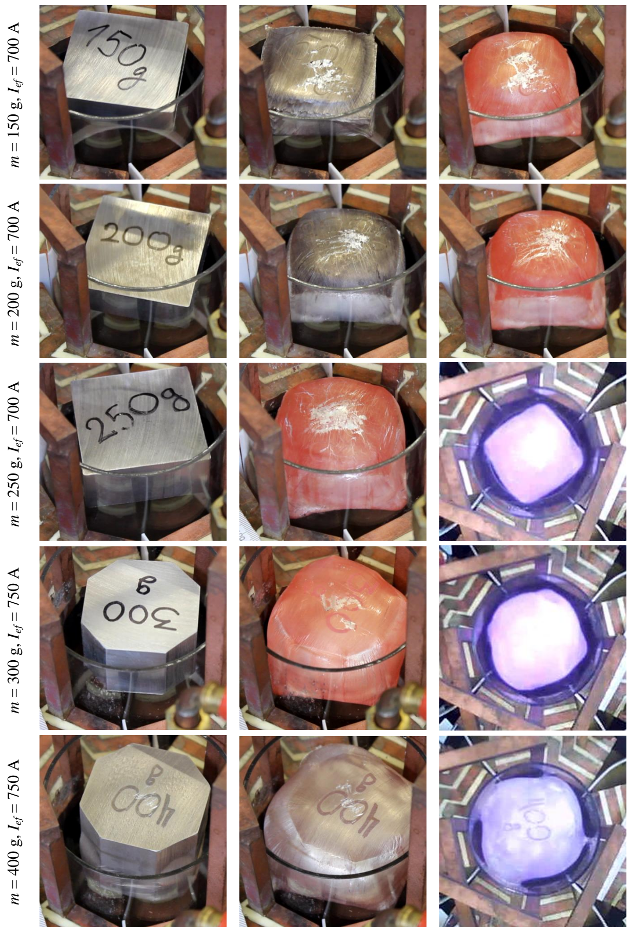
Attēls 22. Eksperimentālie rezultāti alumīnija paraugu levitācijas kausēšanai palielinātā iekārtā
