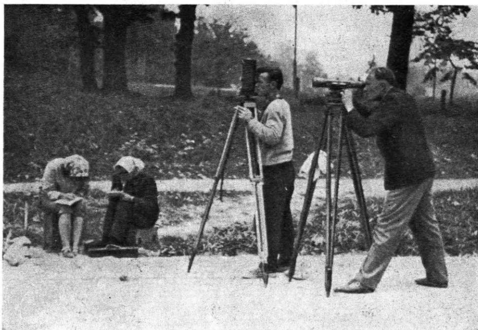
1. att. Precīzās limetpošanas darbi pie Ķokneses 1963. gadā. Darbu vadītājs vec. p. sniedzējs R. Krūpens (no labās) pie precīzā niveliera Ni 004. Darbā labi palīgi ir LLA Zemes ierīcības fakultātes studenti. Pētniecības nolūkos līdztekus tiek izmantots otrs nivelieris Koni 007, pie instrumenta students V. Uplejs. Mērījumus pieraksta studentes V. Brante un L. Spalviņa.
