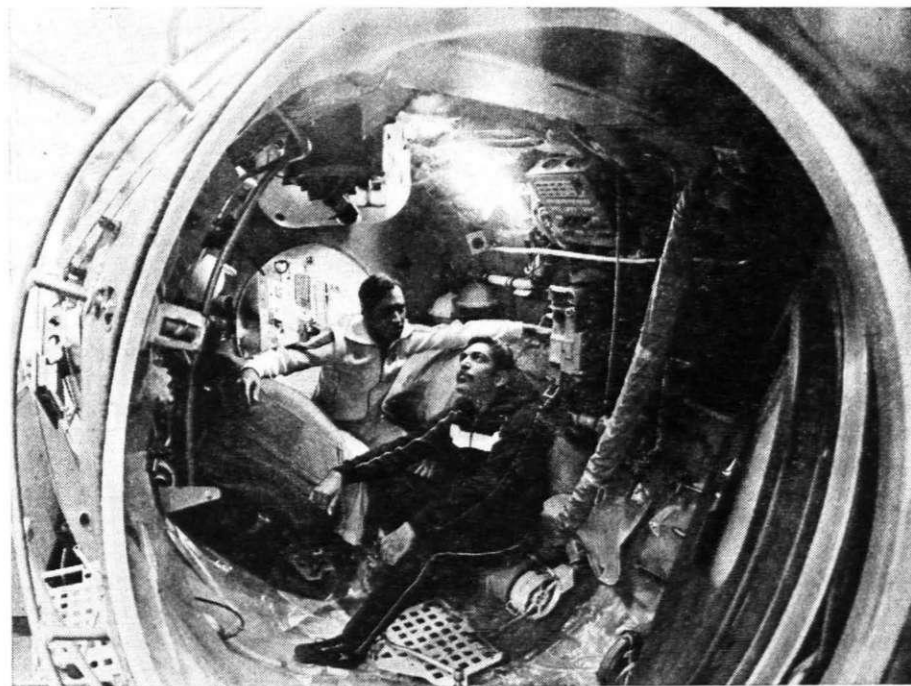
Indiešu kosmonauti Rakešs Šarma un Ravišs Malhotra orbitālās stacijas «Salūts-7» maketa-trenažiera pārejas nodaļā. (TASS fotohronika.)
