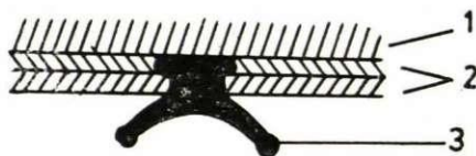
2. att. Jaunajā kosmonautu apavu modeli katrs piesūceknis iztur 1,5 kg lielu atraušanas slodzi. Krāsu attēlā redzamajā izmēģinājuma parauga pazolē ir iestrādāti 24 šādi piesūcekņi. 1 — pazole; 2 — divas kārtas etilēnvinilacetāta mikroporu; 3 — gumijas piesūceknis.
