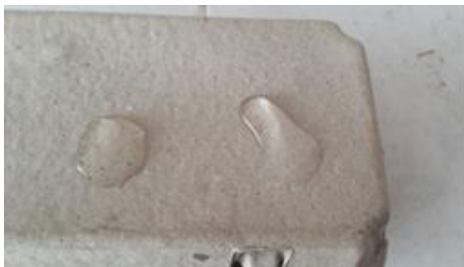
3.22. att. Otrreiz pārstrādātā papīra presētā kartona iepakojamā materiāla prototipa virsmas samitrināšanās vizuālais novērojums pēc 1 minūtes
