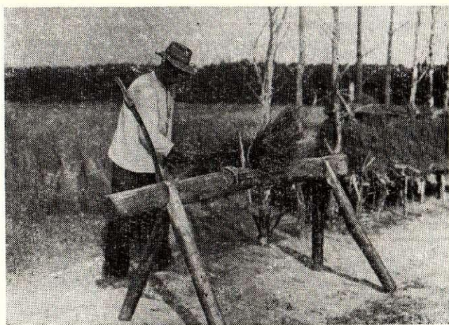
9. att. Līnu sukāšana kozlā. CVVM, 7393. negatīvs.
