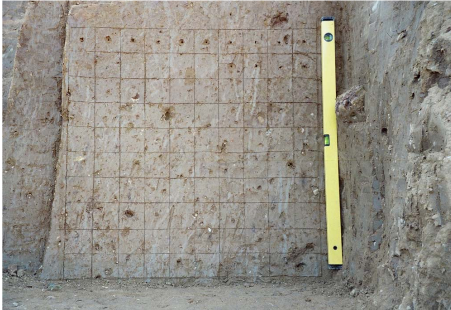
3.1. attēls. Mērījumiem sagatavotā pētījuma vieta (kubs) ar mērījumu tīklu. Mērogam pievienots līmeņrādis, tā garums ir 100 centimetri
