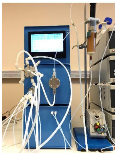
2.5. att. „Sorbomate” automatizētā preparatīvās cietfāzes ekstrakcijas iekārta: pa kreisi – iekārtas fotogrāfija LVKĶI, pa labi – iekārtas shematisks attēlojums
