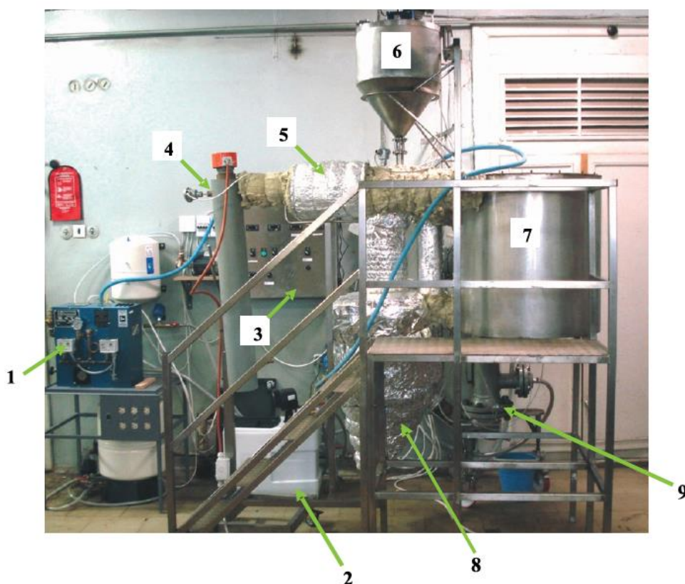
1.3. att. Levoglikozāna iegūšanas iekārta Latvijas Valsts koksnes ķīmijas institūtā [18]: 1. tvaika ģenerators, 2. ūdens sagatavošanas mezgls, 3. vadības panelis, 4. galvenais tvaika pārkarsetājs, 5. palīgpārkarsetājs, 6. barošanas bunkurs ar maisītāju, 7. termoreaktors, kurā notiek pirolīze, 8. ciklons ogļu atdalīšanai, 9. kondensators šķidro produktu savākšanai
