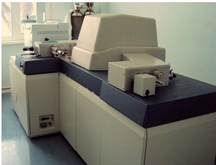
1.19. att. Augstas izšķiršanas spējas masu selektīvs detektors ( AutoSpec Premier, Mycomass technologies ), kas savienots ar Agilent Technologies gāzu hromatogrāfu ( 7683B Series )
