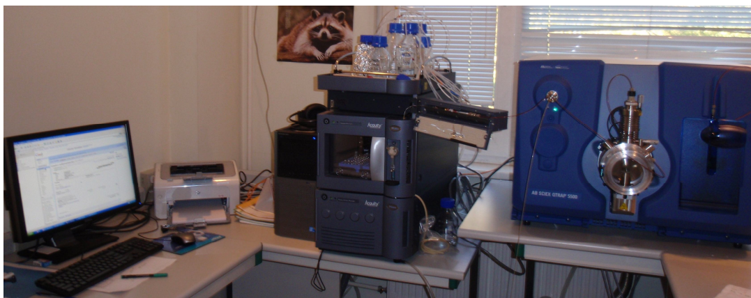
1.22. att. Ultraefektīvais šķidrums hromatogrāfs, kas savienots ar AB SCIEX Qtrap 5500 tandēma masspektrometru (UEŠH-MS-MS)
