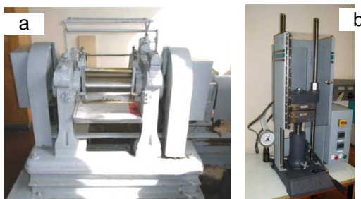
2.2. att. RTU PMI izmantotās iekārtas kompozīciju iegūšanai: a – valči polimēru kompozītu samaisīšanai; b – presēšanas iekārta valcēto kompozīciju plākšņuveida paraugu izgatavošanai
