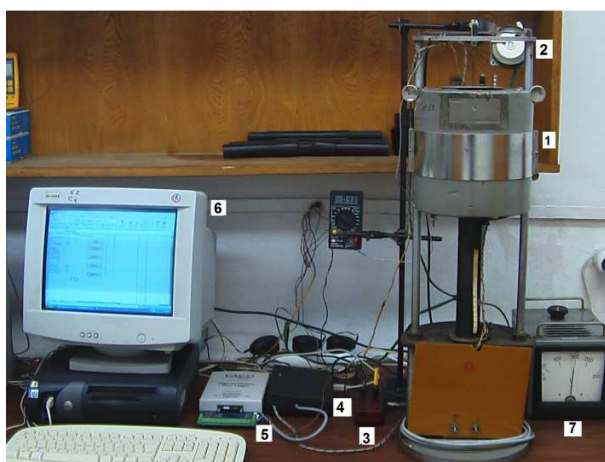
2.12. att. Iekārta termomehānisko līkņu uzņemšanai: 1 – termostats ar tajā ievietotu paraugu; 2 – tilts ar spēka sensoru; 3 – signāla pastiprinātājs; 4 – sildīšanas-dzesēšanas režīma kontrolierīce ar datu apstrādes ierīci (daudzfunkcionālu logeri – 5); 6 – dators, caur kuru tiek vadīts termiskais (sildīšanas-dzesēšanas) režīms un reģistrēti eksperimentālie dati
