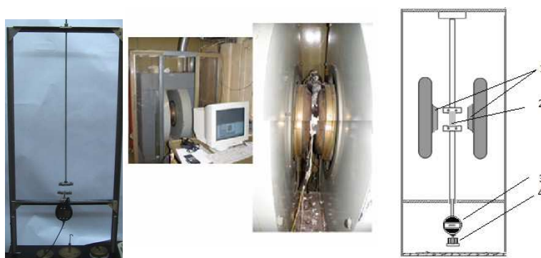
2.8. att. Elektromagnēts un iekārtas shēma īslaicīgās šļūdes mērījumiem magnētiskajā laukā: 1 - magnētu poli, 2 – paraugs, 3 – digitālais indikators deformācijas mērījumiem, 4 - atsvārs
