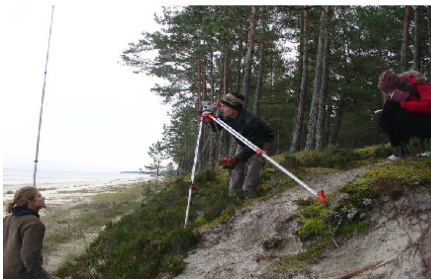
2.4. att. Nivelēšana stacionārajā profilā (autora foto, 2006) Fig. 2.4. Leveling of coastal cross-section (photo by author, 2006)
