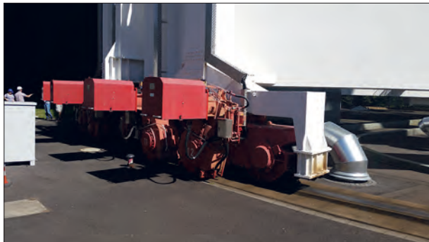
6. att. Efelsbergas 100 m radioteleskopa sliežu sistēmas mehānisms.
