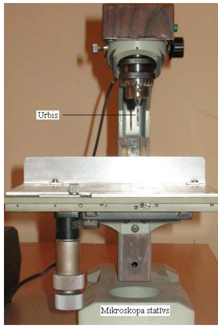
2.15.att. Urbis analizējamā parauga iegūšanai.
