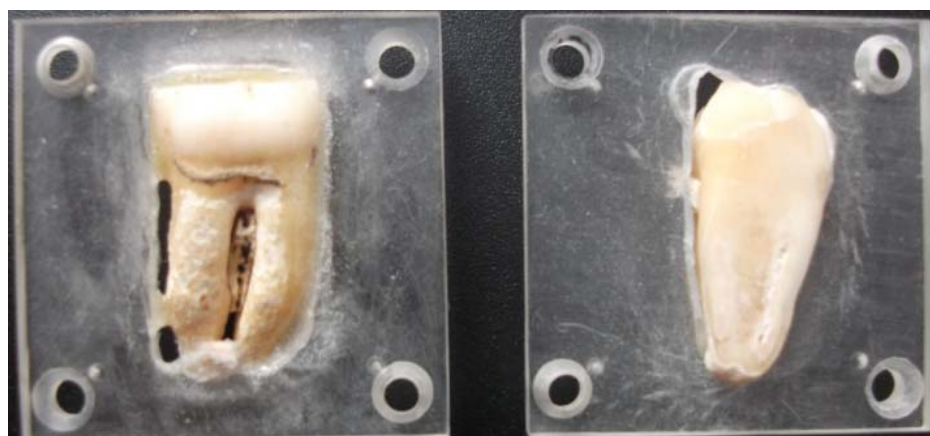
2.16. att. Zabu paraugs pirms un pēc apstrādes ar slīdripu.
