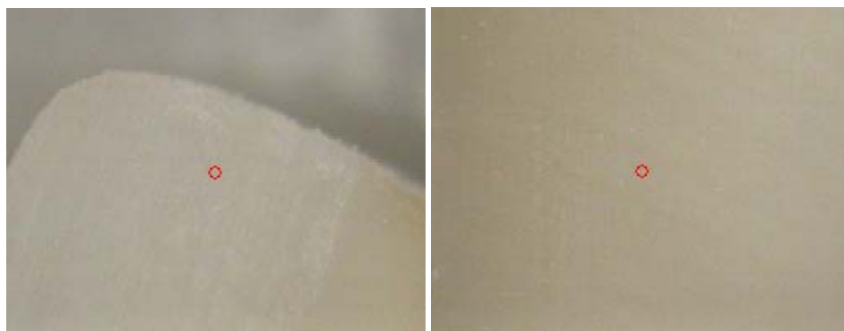
2.17. att. Optiskā mikroskopa pozicionēšanas punkts, metālisko elementu saturs noteikšanai zoba emaljā(a) un dentīnā (b) ar ED-XRF metodi.
