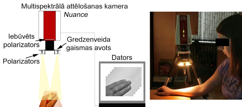
3.1. attēls. Multispektrālās attēlošanas sistēma – darbības shēma un fotoattēls no mērījuma veikšanas [P7].
