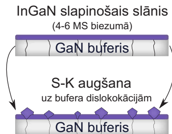
1.4. att. Kvantu punktu SK augšanas uz GaN bufera dislokācijām
