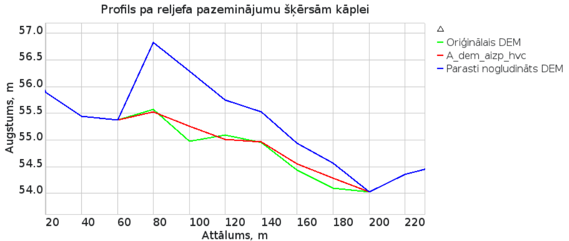
4.1. attēls. Nelielas gravas garenprofils vietā, kur gravu šķērso reljefa modeļa bloka robeža, kura ir izteikta blakus teritorijā, bet ne konkrētās gravas gultnes daļā. Zaļā krāsā - oriģinālie dati; zilā - standarta nogludināšanas rīka piedāvātais risinājums; sarkanā - ar telpiski orientētu matricu iegūts risinājums.
