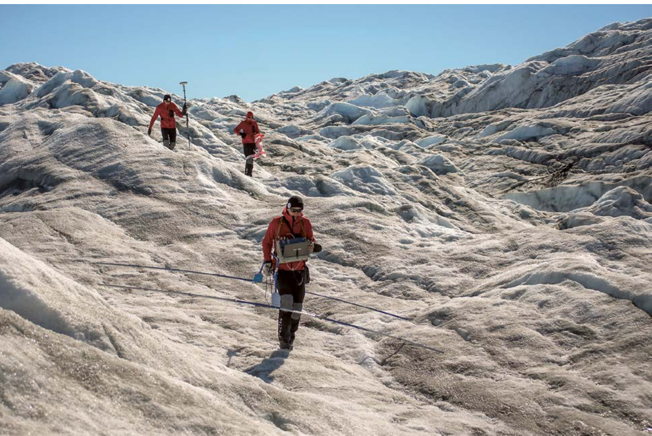
132. att. Radiolokācijas profilu ierakstīšana ar ģeoradaru uz Rasela ledāja. Foto: R. Pāvils, 2016.
