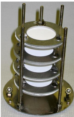
1.1.att. Četri POCIS uzstādīti uz nerūsejošā tērauda izvietošanas statīva
