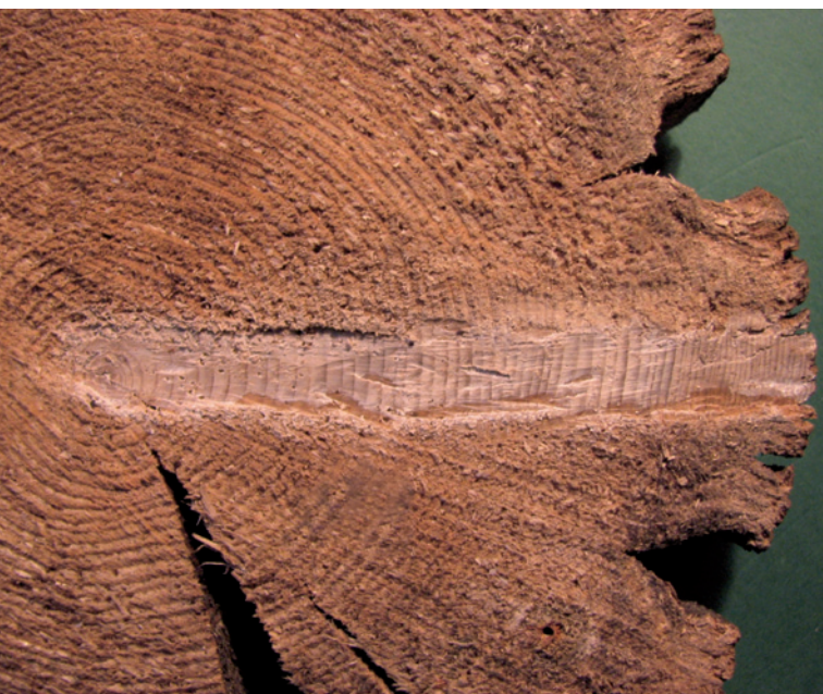
Mērīšanai attīrītās priedes koksnes parauga gadskārtas. To platums liecina par koka augšanas apstākļu maiņu attiecīgā gada veģetācijas sezonā un daļēji arī 1–3 gadus iepriekš
