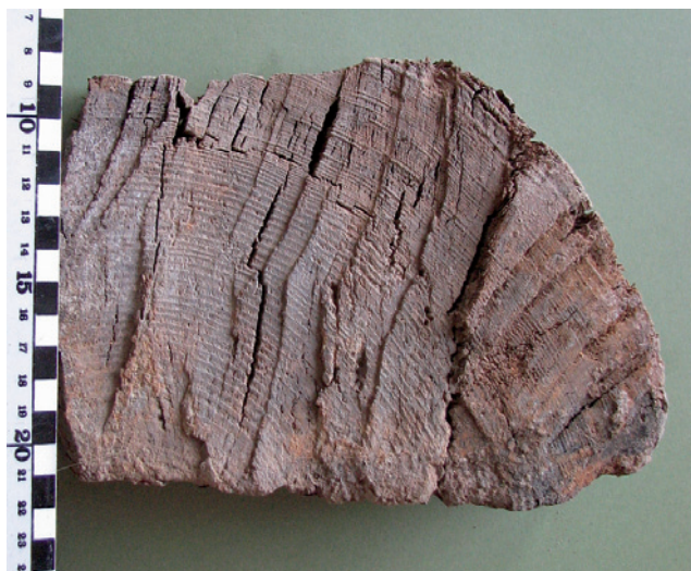
Koksnes paraugs no Cēsīs, Rožu laukumā atklātās 13. gs. noliktavas ēkas koka būvelementa gala. Redzamas ar platasmens cirvi šķērsām koksnes šķiedrai cirstu gludu un dziļu cirtumu pēdas, kas liecina, ka kokmateriāls apstrādes brīdī vēl bijis sveigis, neizžuvis
