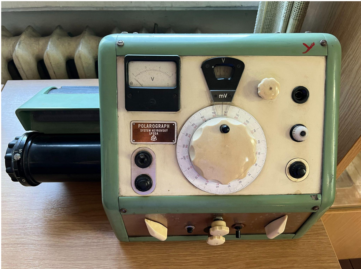
Ražotnes “Laboratornij Prištroj” Čehoslovākijā izgatavotais polarogrāfs LP-55 Latvijas Ķīmijas vēstures muzejā. Foto: Sarmīte Livdāne
