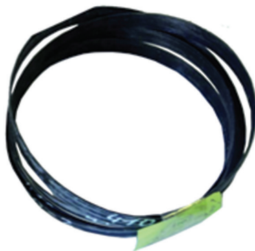
Рис. 1. Кольцевые образцы для испытаний на разрыв.
