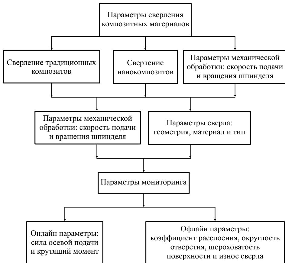
Рис. 2. Параметры сверления композитных материалов.
