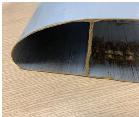
Рис. 3. Фрагмент поперечного сечения конструктивно-подобного образца многослойного закрывка.
