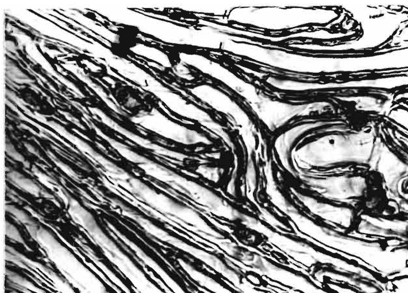
Рис. 23. Тангенциальный срез на границе раннего и позднего слоя годовичного кольца сосны вегетации 1965 года, образованного под воздействием гамма-лучей, D_{13} - 970 р. Увеличение 300.
