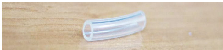
10.6. attēls. Īsa caurule, kuru izmanto savācējmaisa un sorbenta caurules savienošanai
