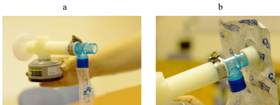
5.5. attēls. T-veida vārstu pievieno savācējierīcei (a) un T-vārstam pievieno izelpas savākšanas maisu (b)
