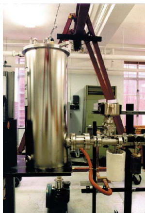
Antimatērijas uzglabāšanas tvertne Mark I . Pennsylvania State University
