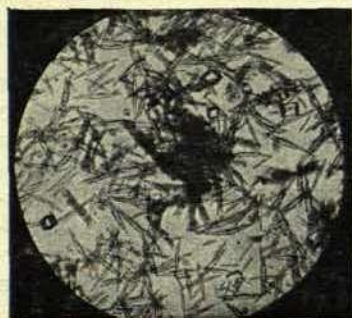
Рис. 19. Кристаллы арагонита из раствора бикарбоната в присутствии гуммиарабика.
