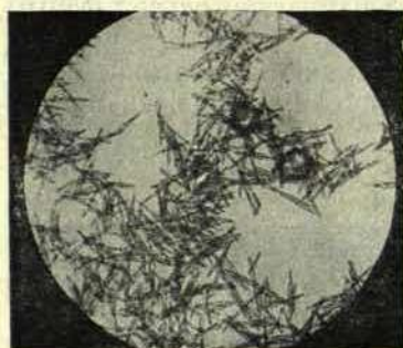
Рис. 13. Кристаллы арагонита из насыщенного раствора бикарбоната кальция.
