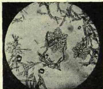
Рис. 21. Кристаллы карбоната кальция из горячего раствора бикарбоната в присутствии карбоната аммония.
