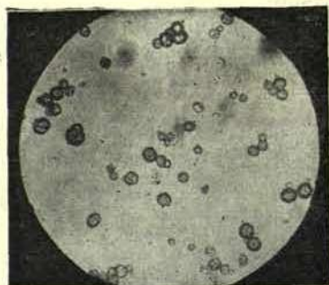
Рис. 3. Кристаллы ватерита, полученные карбонизацией раствора гидроокиси кальция при температуре 10^{\circ} без перемешивания.
