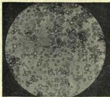
Рис. 8. Кристаллы микрокарбоната кальция, полученные нагреванием при температуре 65° раствора бикарбоната кальция.
