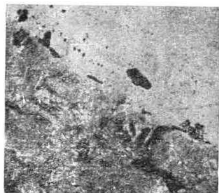
22. att. Isās harpunas vietas A (21. at.) mikrostruktūra. Pal. 100×
