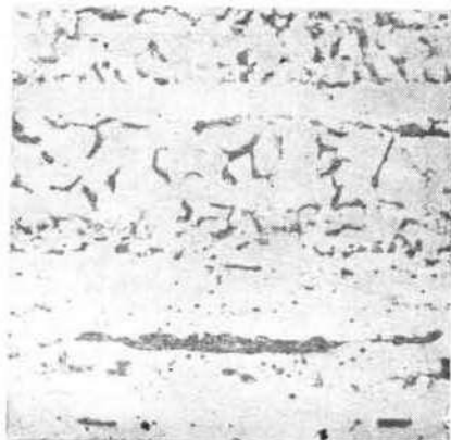
5. att. Uzmavas cīrvja (1. att. — 6) griezuma b-b mikrostruktūra pēc atkvēlināšanas. Pal. 100×
