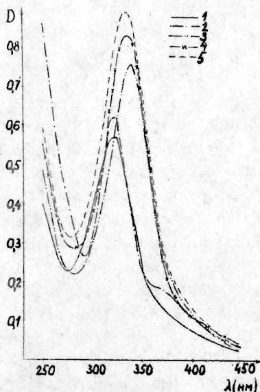
Рис. 5. УФ-спектры поглощения хлороформных экстрактов внутрикомплексных соединений сурьмы (Ш) ( c=10^{-5}M , l = 1 см, c_L / c_M = 30 ). 1 - Дитиобензоат (pH 7,5); 2 - дитиобензоат (pH 2,0); 3 - п-метилдитиобензоат (pH 8,5); 4 - п-метилдитиобензоат (pH 2,0); 5- п - хлордитиобензоат (pH 8,5).
