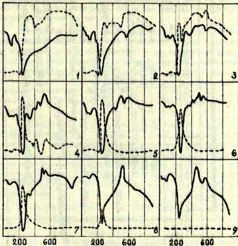
Р и с. 1. Кривые ДТА и изменения электропроводности образцов с содержанием \text{CO} (мол.%) соответственно: 1-10, 2-20, 3-30, 4-40, 5-50, 6-60, 7-70, 8-80, 9-90. — ДТА; ---- электропроводность.
