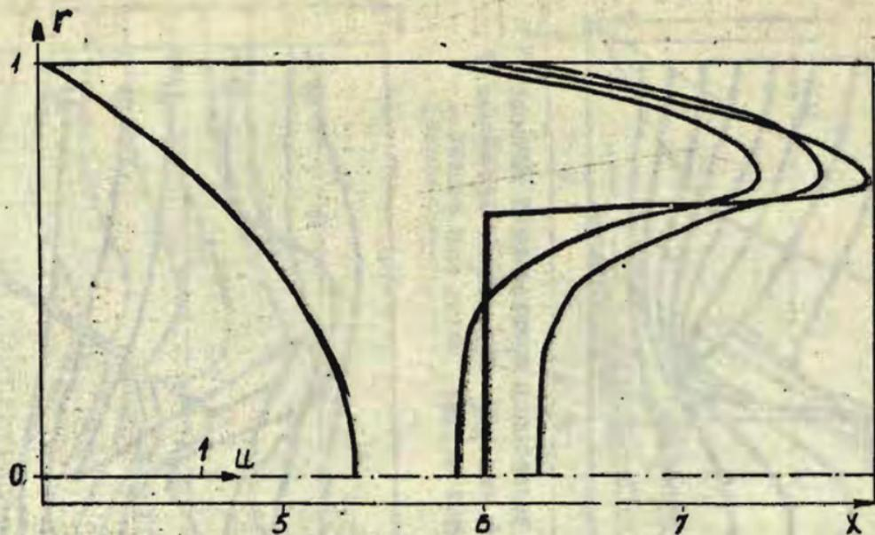
Рис.5. Зависимость продольной составляющей массовой скорости  $gu$  от  $r$  при разных поперечных сечениях. Осесимметричный случай.
