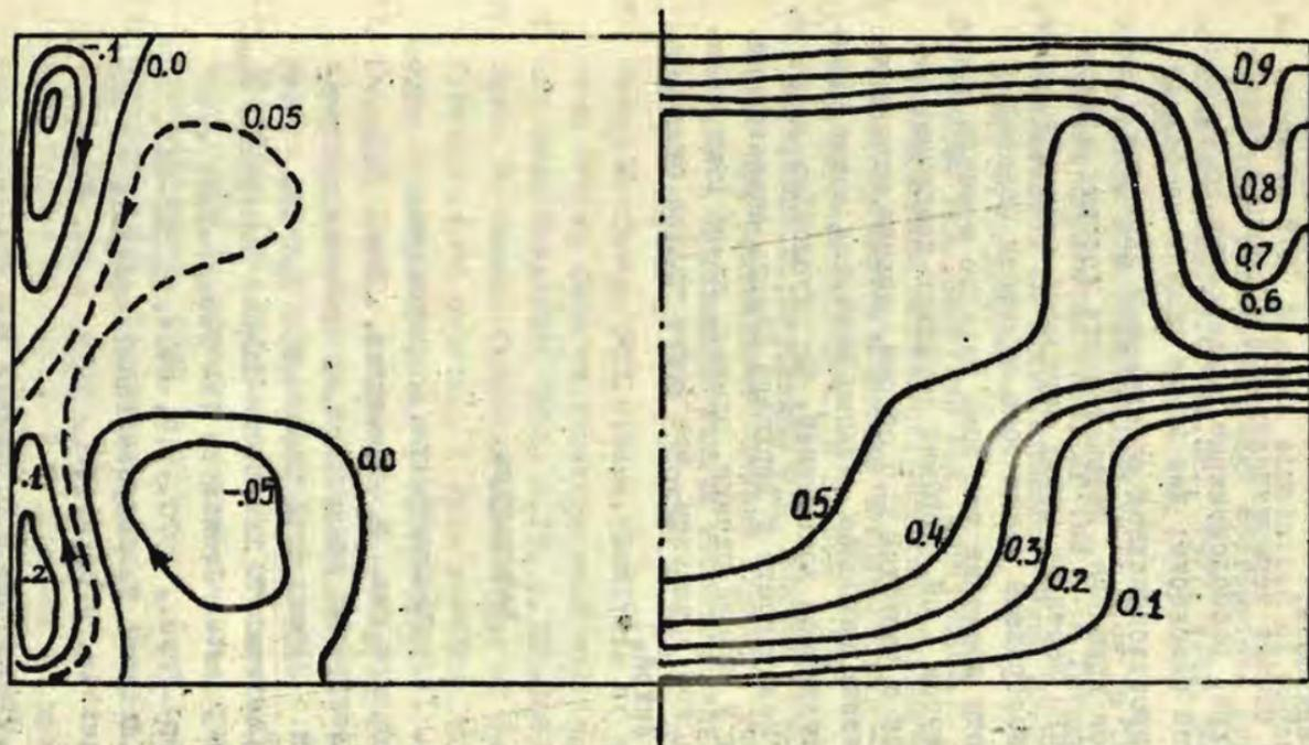
Рис.2. Изолинии функции тока и угловой скорости вращения с учетом естественной и термокапиллярной конвекции при вращении верхнего торца с частотой 0,5 об/сек и неподвижном нижнем торце.
