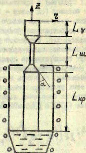
Рис.1. Схема кристаллизации из расплава меди по методу Чохральского.
