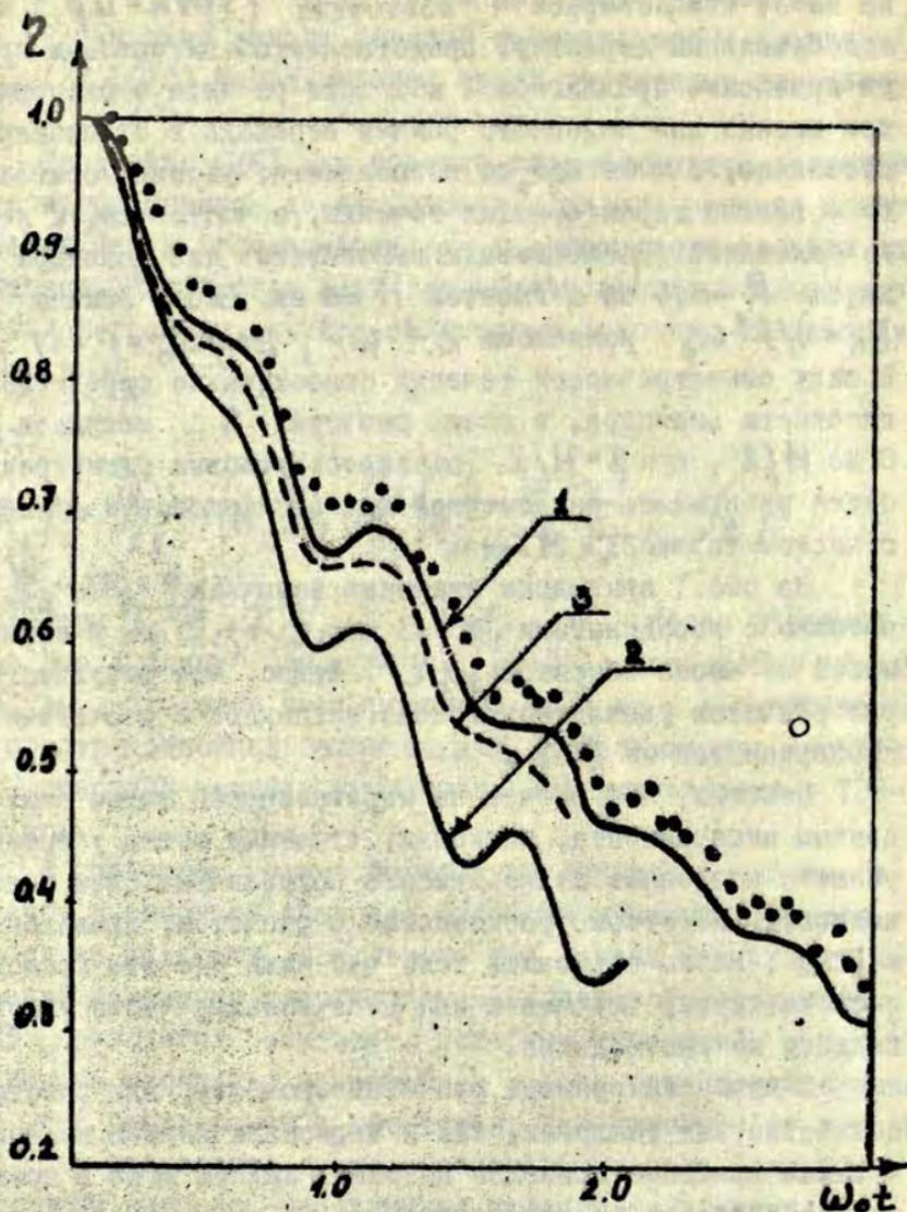
Рис.1. Колебательный характер выхода на стационарное состояние (spin-up);
