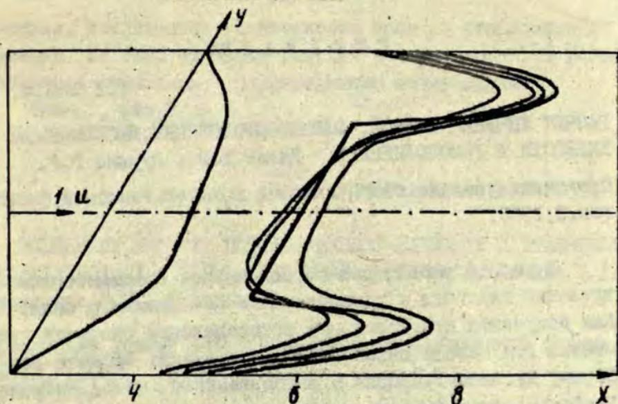
Рис. 8. Зависимость продольной составляющей массовой скорости  $v_{||}$  от  $y$  для разных сечений реактора под углом  $\alpha = 60^\circ$ . Плоский случай.
