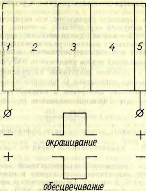
Рис. 6. Структура электрохромного элемента с обратимым анодом.
