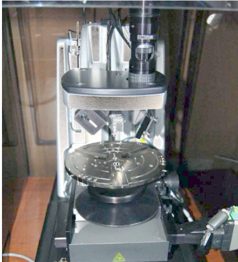
4.2. att. Profilometrs Veeco Dektak 150.
