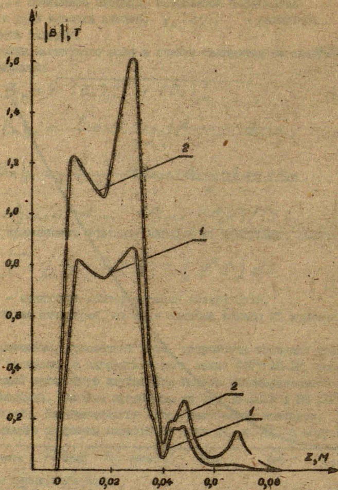
рис. 4. Распределение модуля индукции магнитного поля по оси. Намагничивающая сила 1 - 1000 А, 2 - 2000 А
