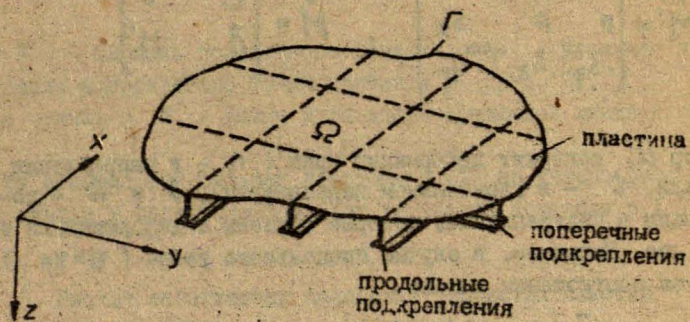
Рис. 1. Пластина с ортогональными подкреплениями
