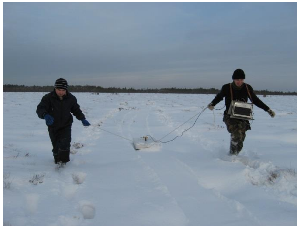
2.3. attēls. Radiolokācijas profilēšana Cenas tīrelī (J. Vībāna foto, 2012. gada decembris) Figure 2.3. Radiolocation profiling in the Cenas tīrelis (Photo by J. Vībāns, December of 2012)
