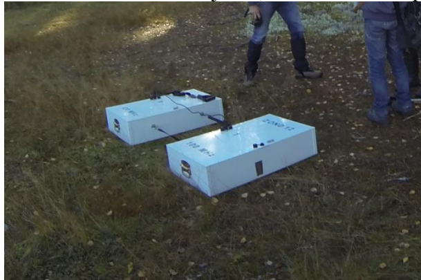
2.8. attēls. SIA RADAR systems ražotā 100 MHz antenu sistēma (2013. gada oktobris) Figure 3.8. The 100 MHz antenna system manufactured by SIA RADAR systems (October of 2013)
