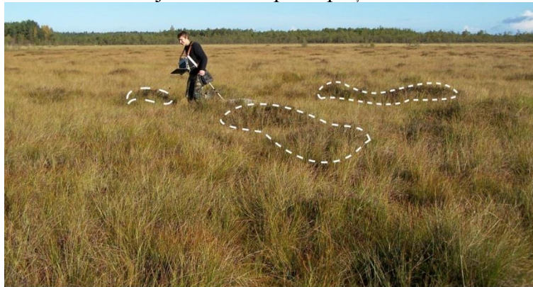
4.4. attēls. Radiolokācijas profilēšana pētījumu objektā Cena (A. Ņelājeva foto, 2014. gada aprīlis)
