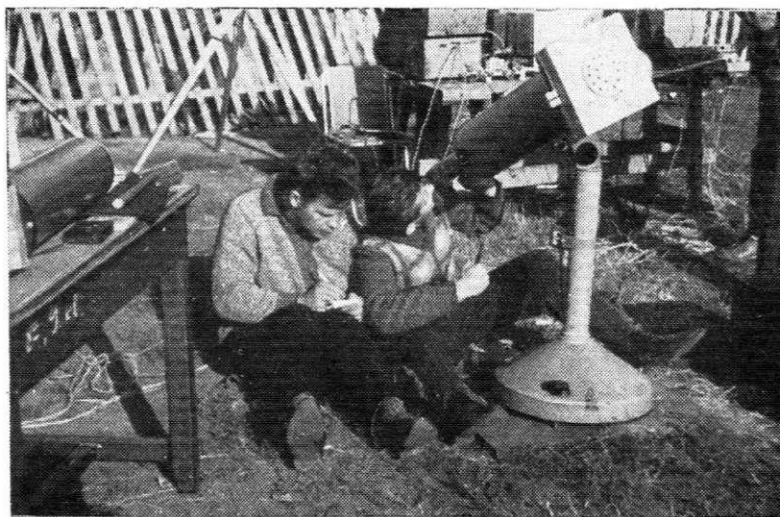
3. att. L. Šmits un J. Miezijs pie Kasegrēna tipa teleskopa (spoguļa diametrs 950 mm, fokusa garums — 2250 mm).
