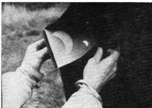
2. att. Aptumšofās Saules sirpītis uz binokulāra ekrāna. Pa kreisi paliel. 40 x, pa labi — paliel. 12 x.
