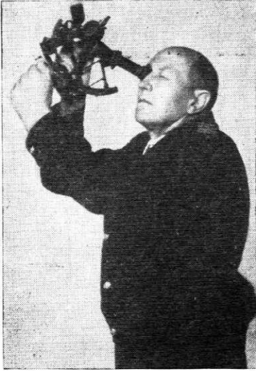
1. att. Spīdekļa augstuma mērišana ar sekstantu atklātā jūrā.
