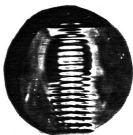
Рис. 6.6.5. Структура свободной поверхности МЖ в переменном магнитном поле частотой 50 Гц. Частота стробоскопического освещения 50 Гц.
