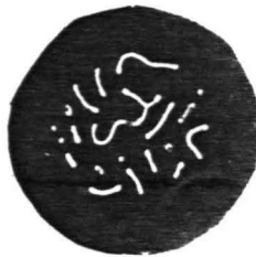
Рис. 3.3.6. Спектр равновесных фигур пузырьков различных размеров. Для малых пузырьков устойчивой остается осесимметричная конфигурация, средних - прямолинейная гантелеобразная конфигурация, а конфигурации достаточно больших пузырьков изогнуты.
