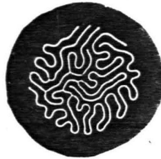
Рис. 3.3.8. Равновесная конфигурация пузырька в МЖ, образуемая при скачкообразном увеличении поля.
