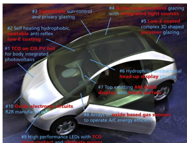
Att. 1.1.1. Aprīkota automobiļa uzbūve ar potenciālām tehnoloģijām, kurās izmantoti caurspīdīgie un elektrovadošie materiāli [18].
