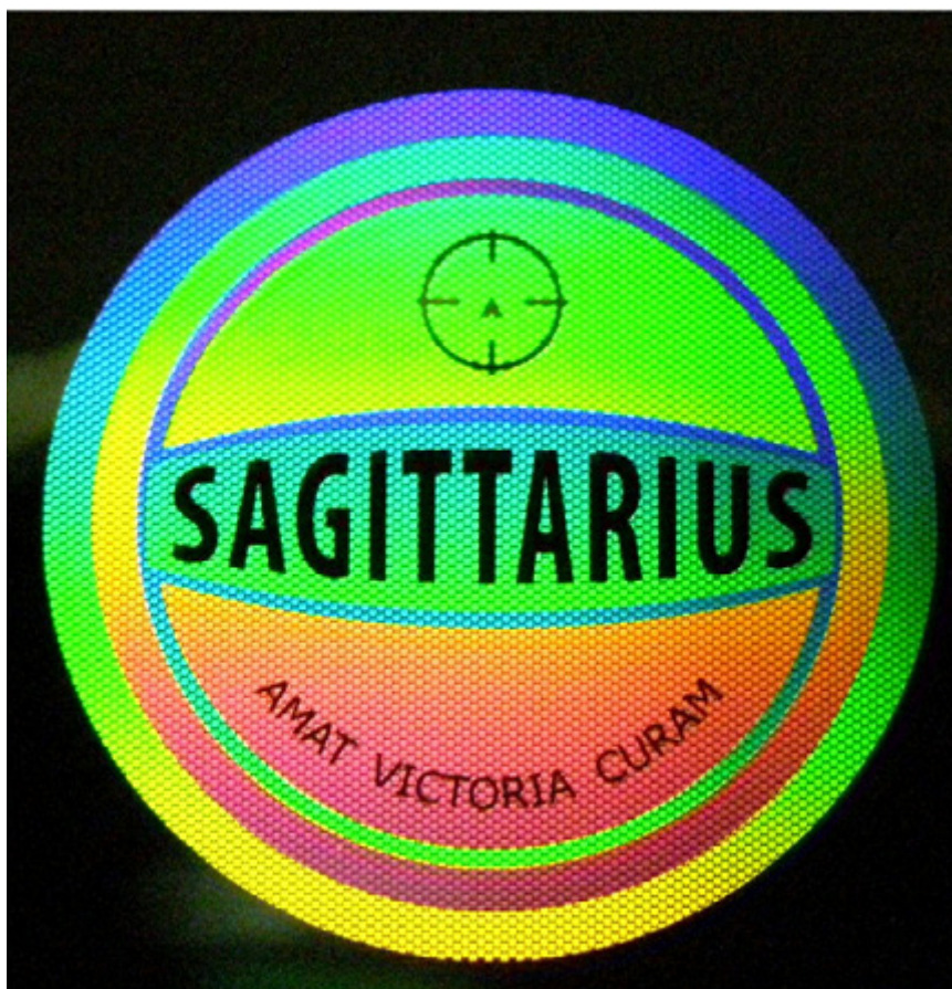
Att. 7.13.1. Reljefa-fāzu hologrammas fotogrāfija. Hologramma ierakstīta iekš KRJ-8 bez kodināšanas procesa. Ieraksta laiks 15h, diametrs – 13.5 mm
