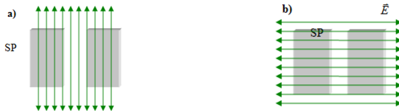
Att. 5.5.3. elektriskā lauka svārstību vektora virziena shematisks attēlojums attiecībā pret spraugu SP; a) – s jeb vektors ir paralēls spraugai; b) – p – jeb perpendikulārs spraugai
