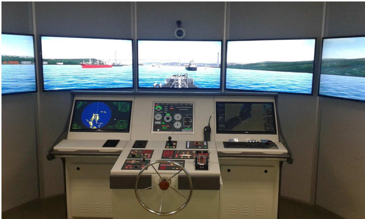
11. attēls. Kuģa tiltiņa simulators “Transas NT PRO 5000”
