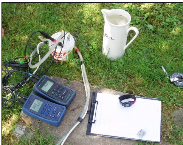
2.4. att. Kwartārsegas pazemes ūdeņu fizikāli ķīmisko parametru noteikšana in situ caurteces traukā ar WTW mikroprocesoriem MultiLineP4 un pH/Cond315 ar atbilstošiem elektrodiem (autores foto, 2005)
