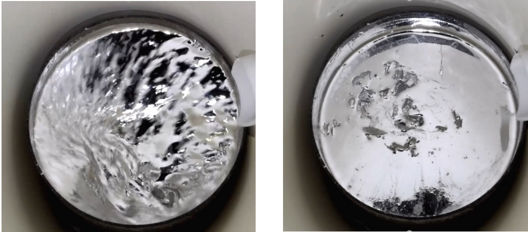
4.56. att. Šķidra InGaSn rezervuārā virsmas attēls pēc 1s ilga laika pēc vienāda daudzuma sacietējoša sakausējuma, kur daļiņu lielums ir 1 – 10 mm ievadīšanas uz metāla virsmas: a) ar metāla maisīšanu ar 45° leņķī attiecībā pret cilindriskā rezervuāra asi diviem pastāvīgo magnētu cilindriem; b) bez maisīšanas
