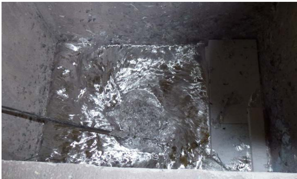
3.39. att. Alumīnija plūsma rezervuārā, izmantojot keramikas ieliktni vertikālās strūkļas bloķēšanai
