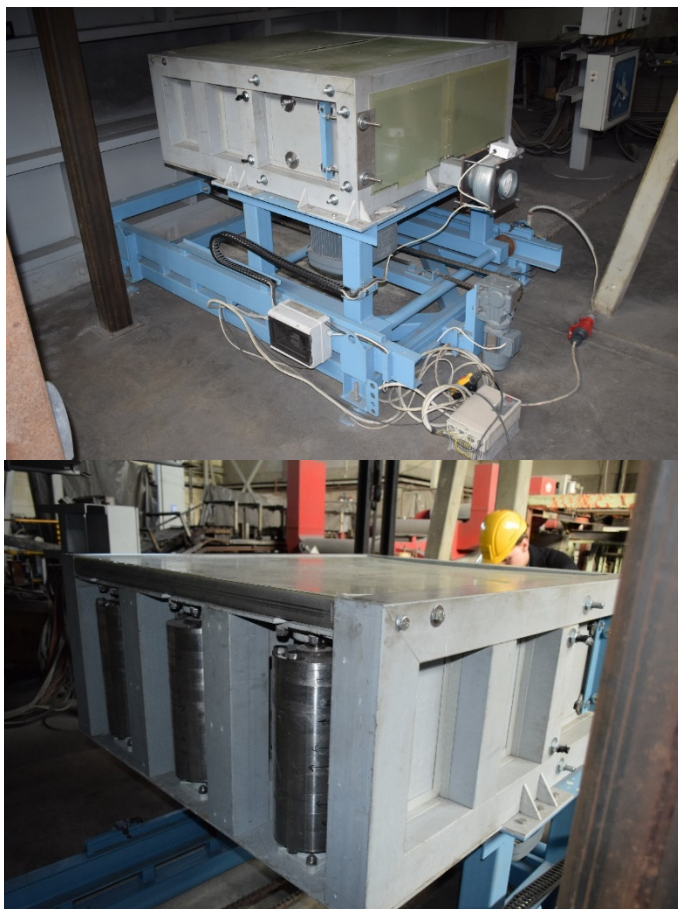
4.46. att. Izgatavotā industriāla mēroga eksperimentālā iekārta ar 3 rotējošiem magnētiskajiem dipoliem 20 t alumīnija krāsnij ar sienas biezumu 20 cm
