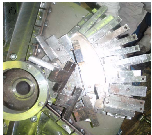
3.30.att. a) Magnētiskā rotora pamatne, uz kuras tika likti magnētiskie poli; b) salikts magnētiskais rotors ar nospriegotām magnētu noturēšanas stīgām un salīmētiem ar epoksīdu sveķiem; c) magnētiskais rotors ar pārklātu papildus epoksīdu un kokskaidu kompozītu slāni magnētu papildus nostiprināšana; d) feromagnētisko tiltiņu izmantošana salikšanas procesā
