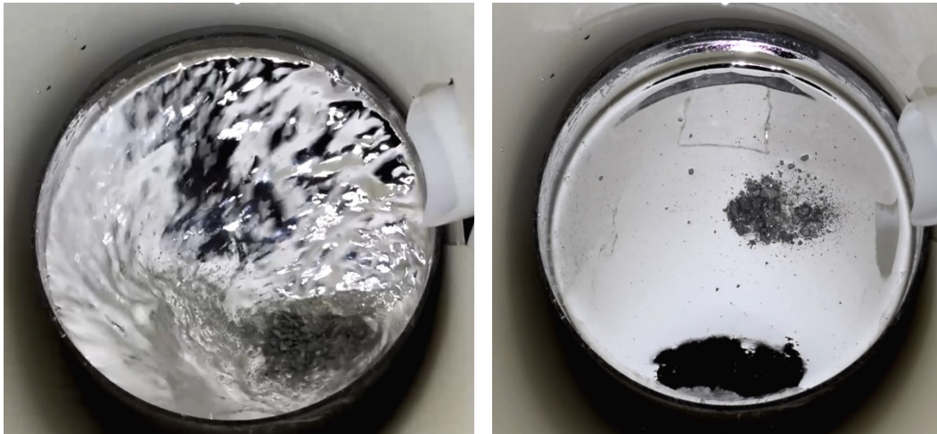
4.57. att. Šķidra InGaSn rezervuārā virsmas attēls pēc 10 s ilga laika pēc vienāda daudzuma sacietējoša sakausējuma, kur daļiņu lielums ir 0.1 - 1 mm ievadīšanas uz metāla virsmas a) ar metāla maisīšanu ar 45° leņķī attiecībā pret cilindriskā rezervuāra asi diviem pastāvīgo magnētu cilindriem; b) bez maisīšanas
