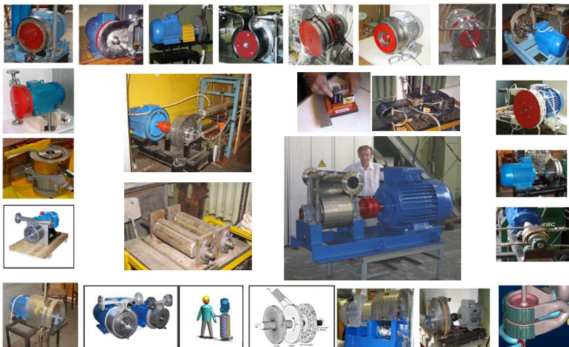
2.2. att. Daži no LUFU izgatavotajiem MHD sūkņi ar pastāvīgajiem magnētiem
