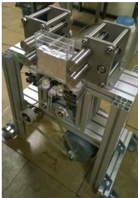
4.64. att. Izgatavotā četru magnētisku dipolu eksperimentālā iekārta
