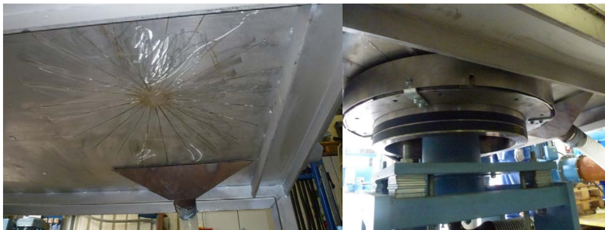
3.34.att. Alumīnija rezervuāra nerūsējošā tērauda apšuvumā iestrādāti speciāli iegriezumi inducēto elektrisko strāvu noslēgšanās un attiecīgi izdalītā Džoula siltuma ierobežošanai un papildus gaisa dzesēšanas pievads radītā siltuma aiznesšanai
