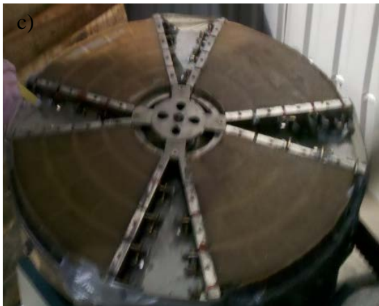
3.30.att. a) Magnētiskā rotora pamatne, uz kuras tika likti magnētiskie poli; b) salikts magnētiskais rotors ar nospriegotām magnētu noturēšanas stīgām un salīmētiem ar epoksīdu sveķiem; c) magnētiskais rotors ar pārklātu papildus epoksīdu un kokskaidu kompozītu slāni magnētu papildus nostiprināšana; d) feromagnētisko tiltiņu izmantošana salikšanas procesā
