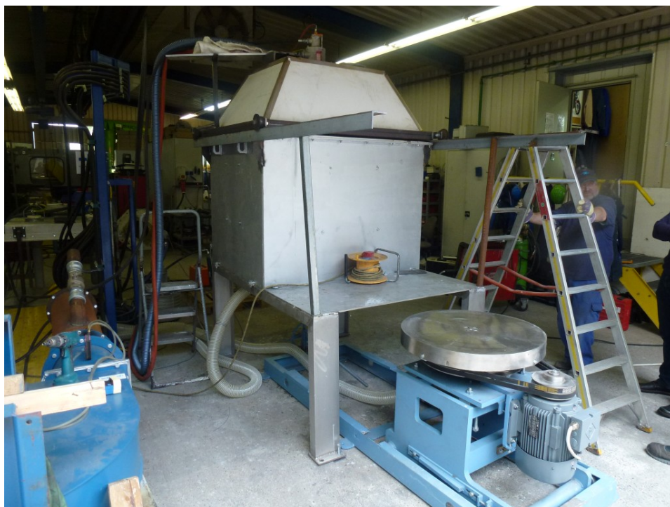
3.32.att. Centrbēdzes iekārta uzstādīta eksperimentālajiem testiem ar alumīniju
