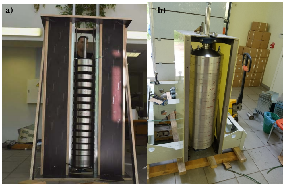
4.23. att. Industriāla mēroga pastāvīgo magnētu dipola salikšana, izmantojot diskveida nerūsējošā tērauda ietvaru: a) cilindrs salikšanas procesā; b) salikts cilindrs jau ievietots rāmī
