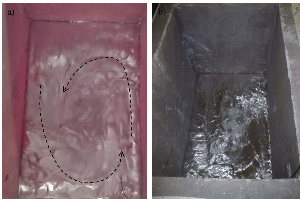
3.36. att. Alumīnija plūsmas rezervuārā gadījumā, kad rezervuārs ir bloķēts, uzņemot fotogrāfijas bez a) un pie ~ pie 12 rotora apgriezieniem sekundē un ar b) zibspuldzi un pie ~10 rotora apgriezieniem sekundē
