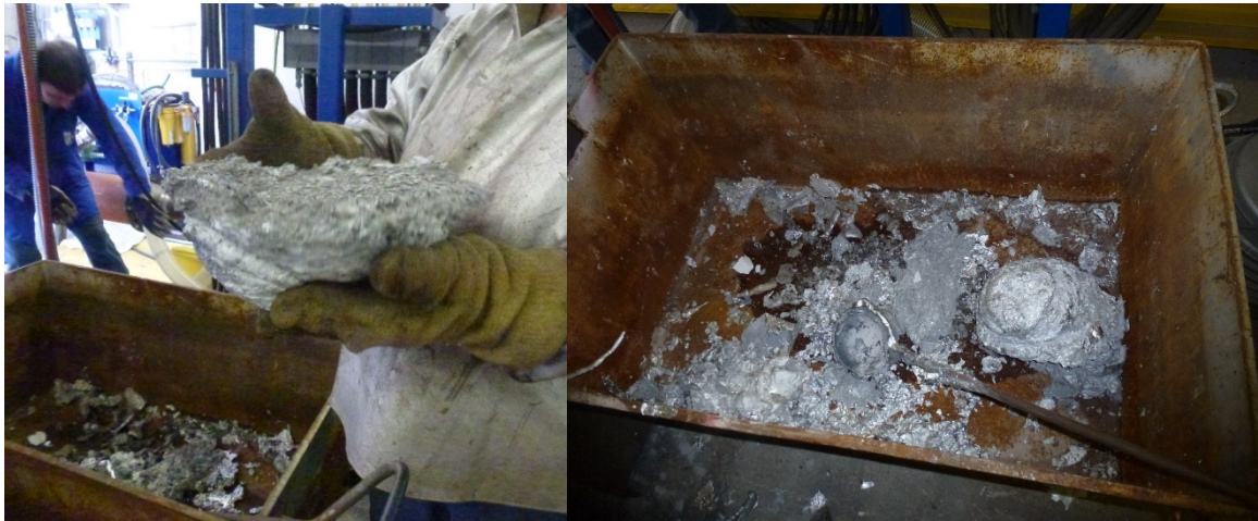
3.38. att. Eksperimentu laikā radītie alumīnija oksīdi pārāk spēcīgas plūsmas dēļ
