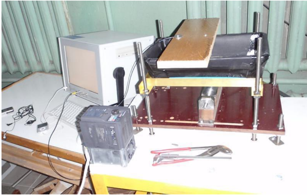
4.13.att. Eksperimentālā iekārta viena rotējoša magnētiskā dipola radītās plūsmas taisnstūrveida rezervuārā izpētei
