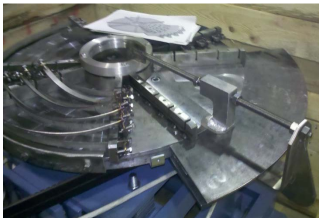
3.29.att. Izstrādātā magnētu stiprināšanas sistēma magnētisko polu izveidošanai, un izstrādātie un izgatavotie speciālie palīgīdzekļi magnētiskās sistēmas salikšanai
