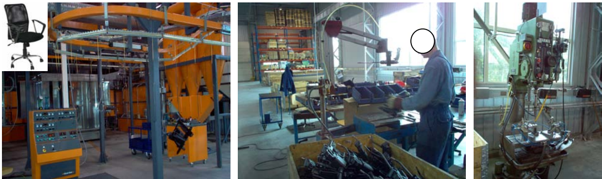
2.35. att. Datorkrēslu metālu atbalstu ražošanas procesa posmi (krāsošana, montāža, metināšana)
